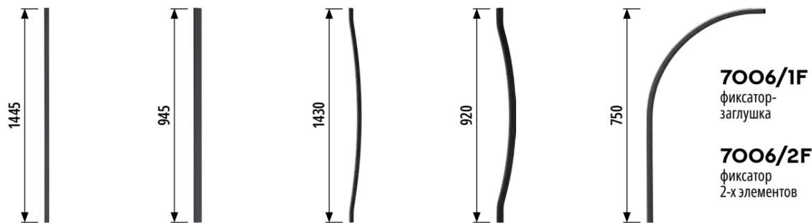
**7006/150** LED x 21W, 600 lm угол рассеивания 120°
