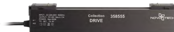
IP 20 Драйвер Корпус алюминий Выходная мощность 200 Вт Выходное напряжение 48 В Входное напряжение 200–240 В (Д*Ш*В) 281*38*50 мм
