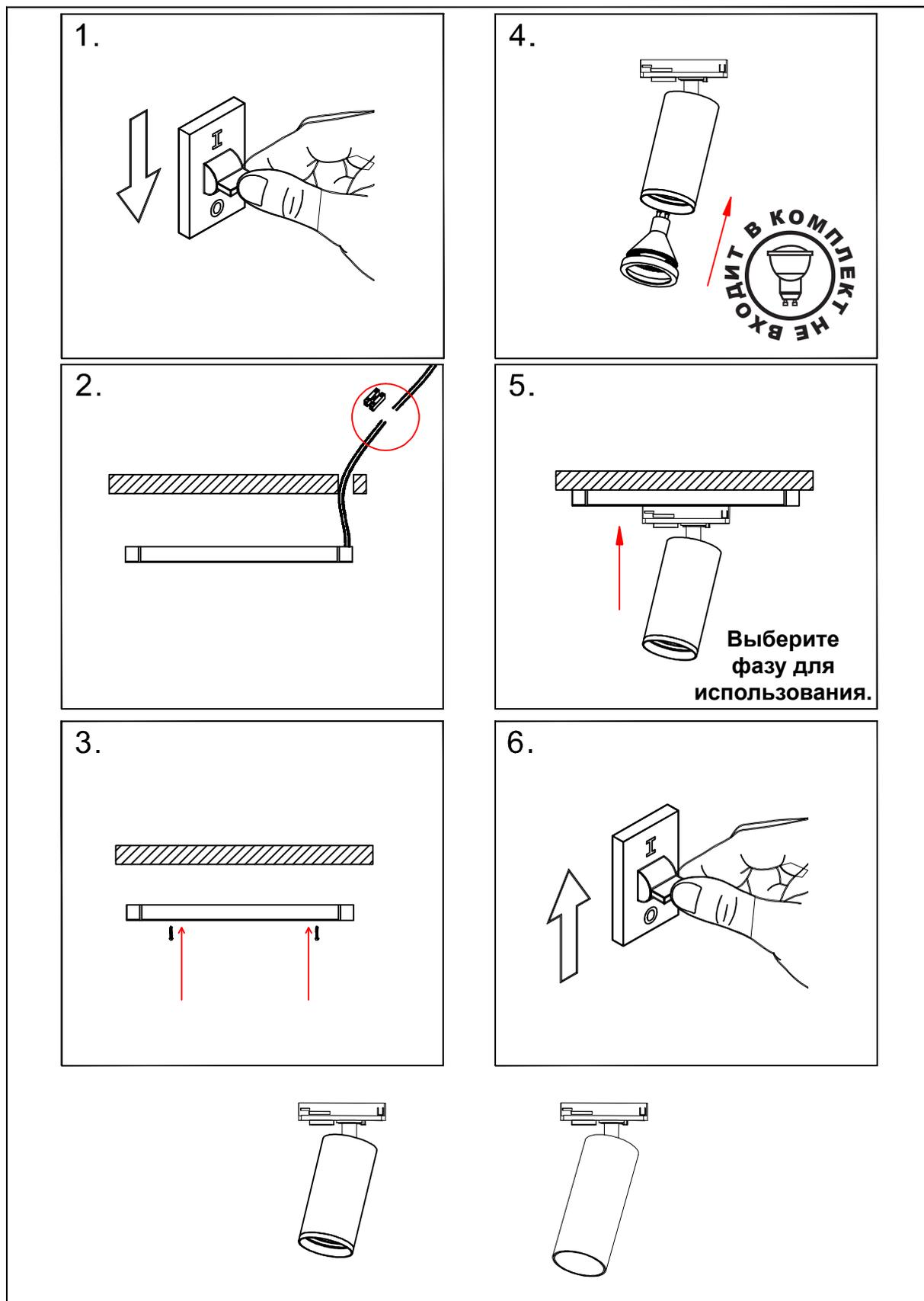
**ВНИМАНИЕ.** Все работы по монтажу шинпровода и установке светильников, замене ламп и техническому обслуживанию следует проводить при отключенном напряжении питания шинпровода.
