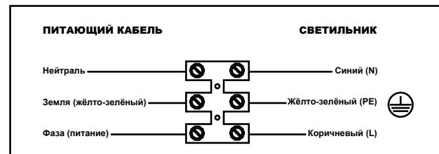
Имея правильно идентифицированные жилы питающего кабеля, осуществите их подключение к клеммному блоку светильника следующим образом.
