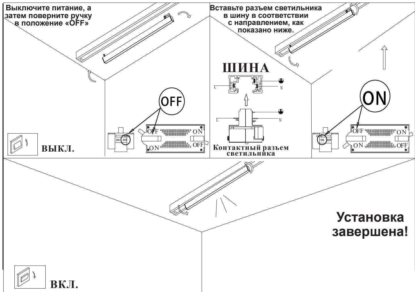
**ВНИМАНИЕ.** Все работы по монтажу шинопровода и установке светильников, замене ламп и техническому обслуживанию следует проводить при отключенном напряжении питания шинопровода. Категорически запрещается производить перемещение светильников вдоль шинопровода во включенном состоянии.
