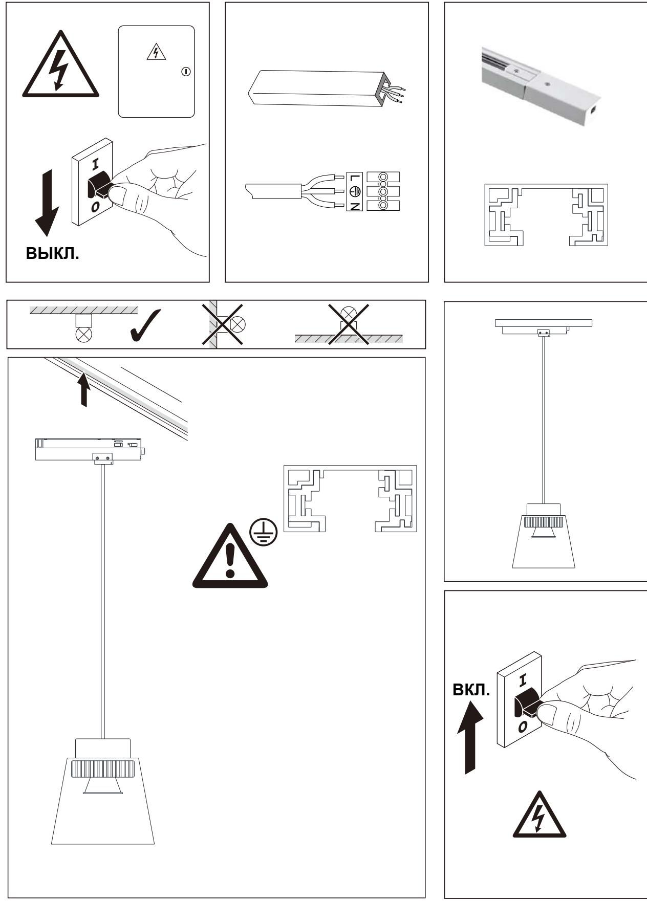
**ВНИМАНИЕ.** Все работы по монтажу шинопровода и установке светильников, замене ламп и техническому обслуживанию следует проводить при отключенном напряжении питания шинопровода. Категорически запрещается производить перемещение светильников вдоль шинопровода во включенном состоянии.
