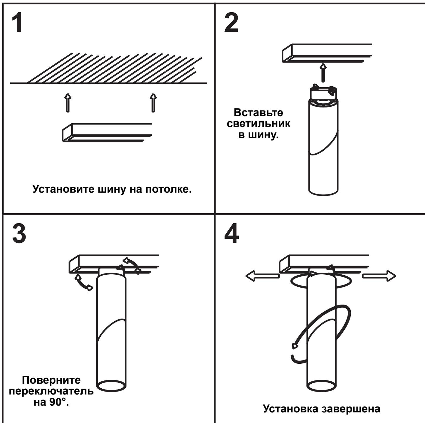
**ВНИМАНИЕ.** Все работы по монтажу шинопровода и установке светильников, замене ламп и техническому обслуживанию следует проводить при отключенном напряжении питания шинопровода.
