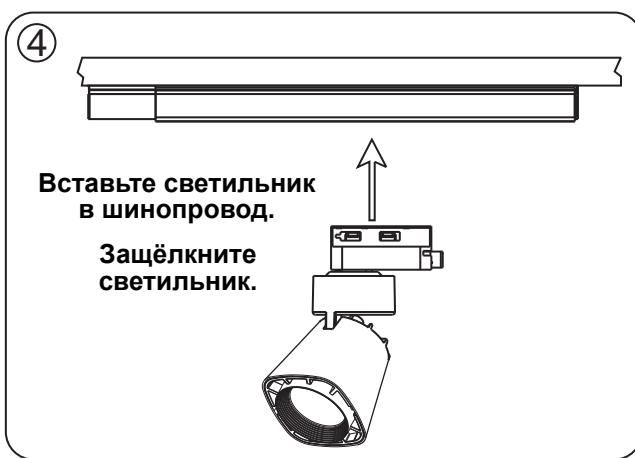
**ВНИМАНИЕ.** Все работы по монтажу шинопровода и установке светильников, замене ламп и техническому обслуживанию следует проводить при отключенном напряжении питания шинопровода.
